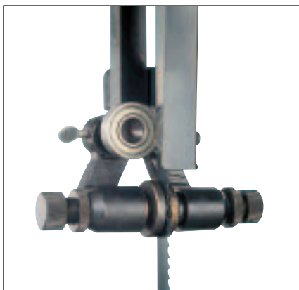
Ghidaj de precizie cu reglaj fin
