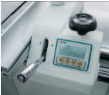
Ghidaj paralel cu indicator digital ca accesoriu
