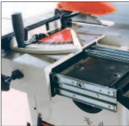
Sania se regleaza foarte usor cu suruburi de reglare
