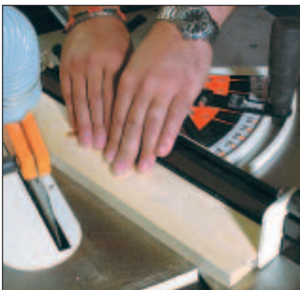
Taierea de unghiuri ascutite cu ajutorul dispozitivului de taiere la unghi
