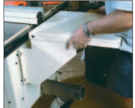
Prelungirea din spate a mesei (standard) se demonteaza pe sistem baioneta
