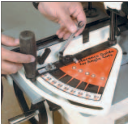
Dispozitiv de precizie, de taiere la unghi cu rotire la 0°/90°/135°. Suporturi de capat reglabile.
