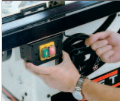
Intrerupator de pornire/oprire in pozitie de lucru optima; poate culisa pe intreaga latime
