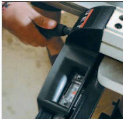
Ghidaj paralel patentat Micro-Glide cu reglaj fin si lupa
